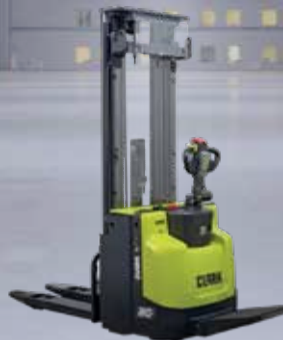
Hochhubwagen Plattformausführung 1200 / 1600 kg
